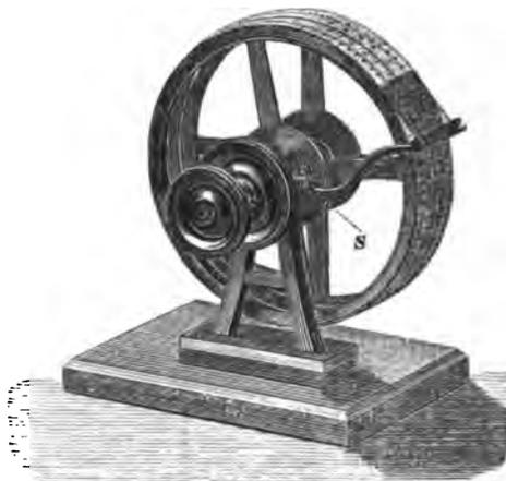
bleibt. An einem festen Träger befindet sich vorne, an den Rädern anliegend, ein Stück Gelatinepapier mit einer zur Axe parallelen roten Linie. Um  $x = \frac{a}{b} \cdot c$  zu finden, dreht man erst beide Räder zusammen und dann das rechte Rad allein so, dass die Stelle a der logarithmischen Teilung links, und die Stelle b derjenigen rechts unter die rote Linie
